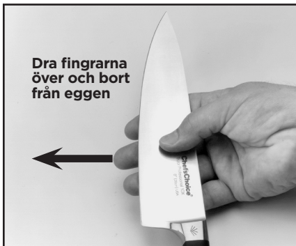
Figur 7. Detektera slipgraden genom att dra fingrarna över och bort från eggen. Iaktta försiktighet! Se texten.
