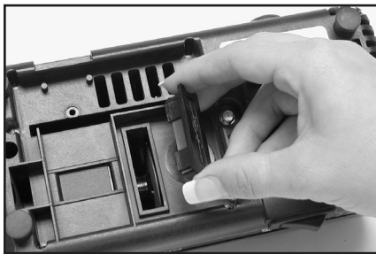
Bild 11. Ta bort luckan under botten för att rengöra metalldammet.
